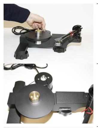
FIT THE DRIVE BELT BY LOOPING OVER THE DRIVE HUB, THEN STRETCHING OVER THE DRIVE PULLEY.
