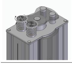
Schrauben Sie die Röhrenabdeckung im Urzeigersinn fest.
