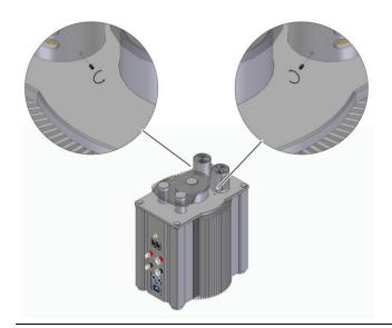
Erdungsschrauben mit Hilfe des beiligenden Inbusschlüssels entfernen.
