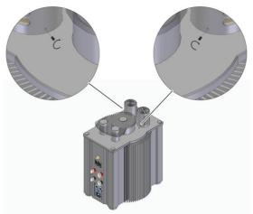
Abschließend die Erdungsschrauben einsetzen und fest anziehen.
