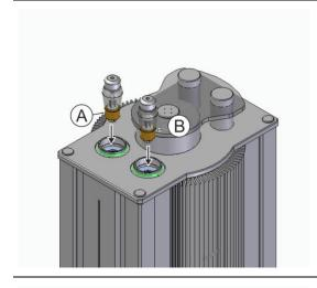
Röhren wie gezeigt einsetzen (auf Kennzeichnung am Röhrensockel achten).
