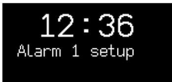
Следуйте инструкциям на дисплее для установки времени будильника, продолжительности срабатывания, источника сигнала, а также громкости, используя **КОЛЕСО УПРАВЛЕНИЯ**. Поворачивайте его для навигации по опциям и нажимайте на него для подтверждения выбора.
