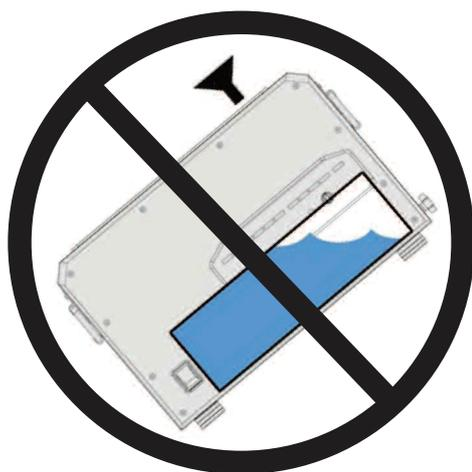
Не наклоняйте агрегат во время залива воды!
