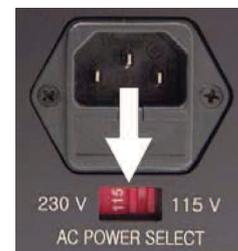
Перед включением селектор сетевого напряжения «AC Power Select» должен быть установлен в положение, соответствующее напряжению в сети переменного тока.
