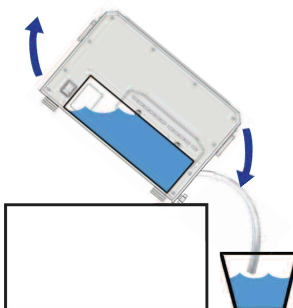
Как только резервуар будет полностью опорожнен, отверните крышку резервуара на задней стенке агрегата. Если агрегат предполагается пересылать или перевозить на другое место, внутрь резервуара желательно поместить бумажную салфетку для впитывания остатков влаги, после чего крышку необходимо установить в изначальное положение.
